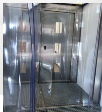
Caillebotis en acier galvanisés et Flaps entre chaque compartiment pour plus de sécurité.
