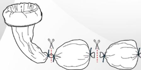
Principe de fonctionnement et d'usage du système Longopac à ensachage infini.
