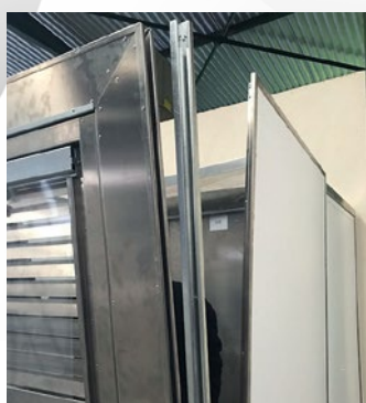
Système d'imbrication sans outil des panneaux sur les baguettes.
